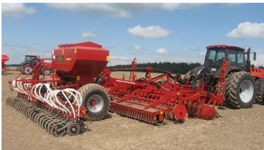
Рисунок 13. – Агрегат почвообрабатывающе-посевной многофункциональный АППМ-6 с дисковыми рабочими органами
