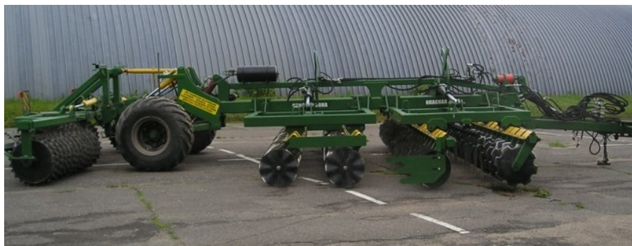
Рисунок 9. – Агрегаты комбинированные для минимальной обработки почв АКМ-4 и АКМ-6
