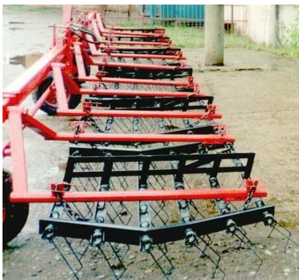
Рисунок 3. – Агрегат бороновально-пропалочный АБ-9 производства ОАО «Дрогичинский трактороремонтный завод»
