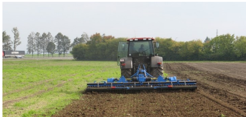
Рисунок 8. – Агрегат комбинированный почвообрабатывающий с активными рабочими органами АКП-6
