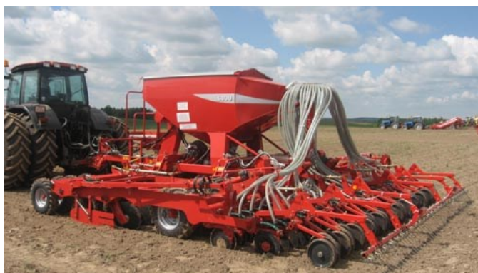
Рисунок 13. – Агрегат почвообрабатывающе-посевной многофункциональный АППМ-6 с дисковыми рабочими органами
