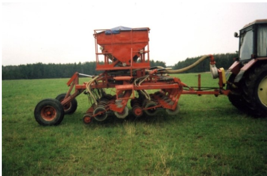
Рисунок 4. – Сеялка зернотукотравяная прямого посева СПП-3,6
